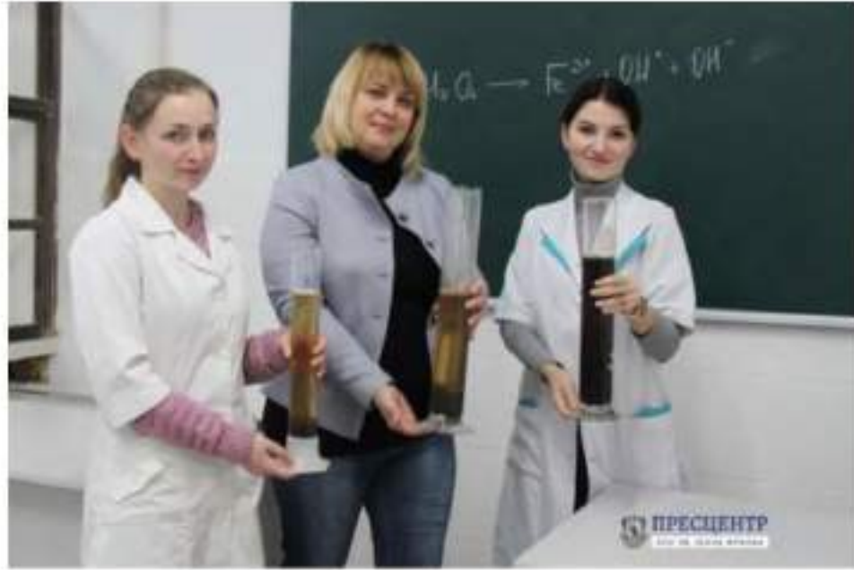
Фото 2.15 Інфільтрат до та після очистки (фото з інтернету)
